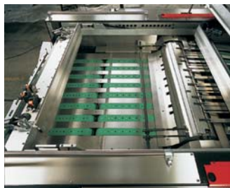
Synchrontransfer mit automatischer Anpassung der Übergabegeschwindigkeit zum Trockner.
