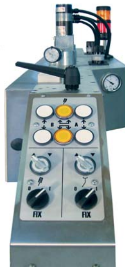
Motorisierte Raketzustellung zur automatischen Höhenjustage und Parallelstellung.
