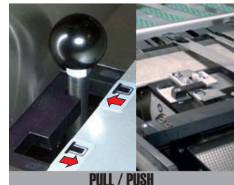
Vakuum-Seitenmarke multifunktional: zusätzlicher Schiebemodus für schweres Material.
