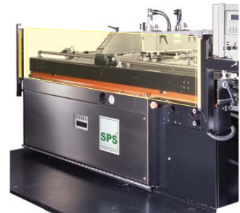
Erweiterte GS Bediener-sicherheit : Lichtvorhänge mit begrenzter Passivschaltung
